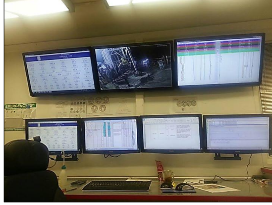
Şekil 5.12. Mudlogging ünitesi içerisinde bir görünüm. Sondaja dair tüm kritik bilgiler bu üniteye toplanır ve birçok ekran ile anlık olarak takibi yapılır
